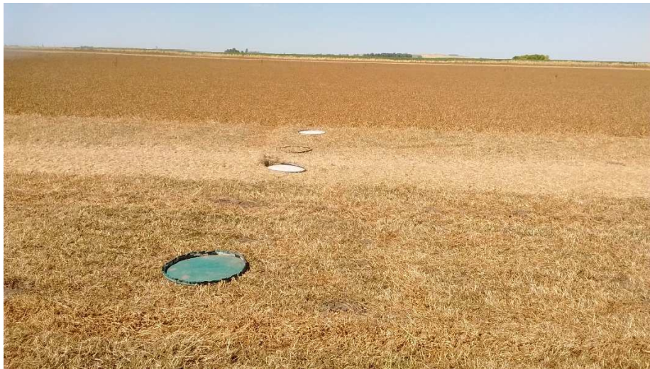
Aros colocados para la determinación de pérdidas por cabezal y cola
