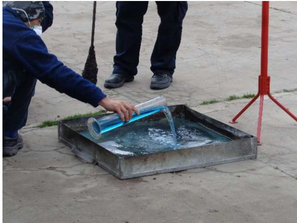
Figura 7: Bandeja testigo (B) con mezcla de agua y 5 litros de nafta.
