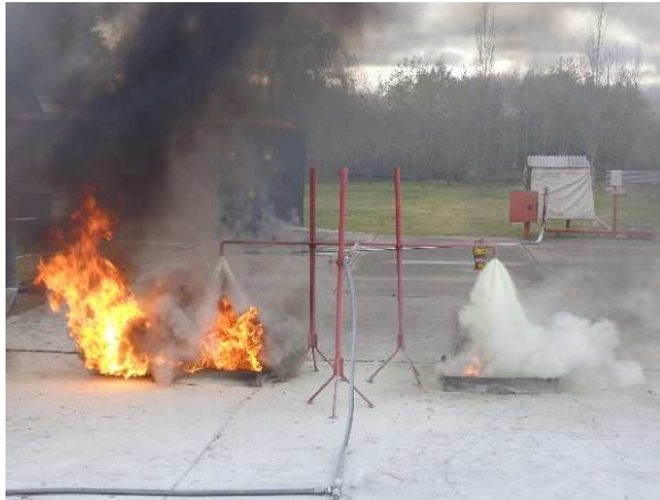
Figura 11: Etapa de extinción donde se observa el comienzo del trabajo del agente extintor ABC 90 expelido por las toberas de prueba sobre las bandejas de evaluación.
