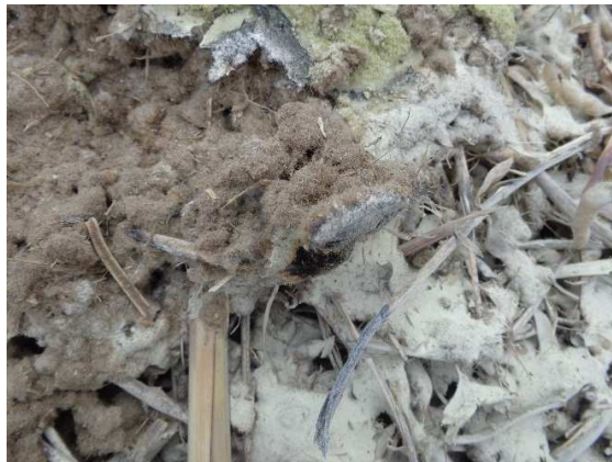
Figura 13: En las bandejas de evaluación, luego de la etapa de extinción, se evidencio que el agente extintor ABC 90, encapsula a los focos de fuego, privándolos de Oxígeno y minimizando los riesgos de reignición.
