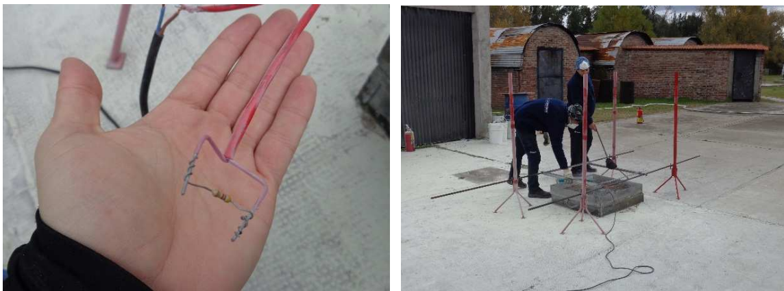
Figura 12: Izquierda: cable detector del sistema ABC 90. Izquierda: operarios montando el bastidor con el cable detector sobre la bandeja de evaluación con combustible clase "B".
