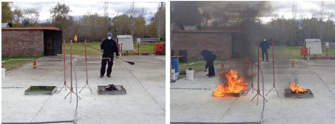
Figura 9: Derecha: operario listo para encender las bandejas de evaluación “A” y “B”. Izquierda: periodo de combustión de 20 segundos buscando lograr una temperatura importante.
