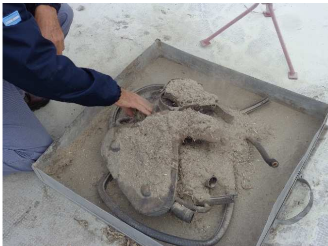
Figura 8: Bandeja de evaluación preparada con combustible tipo “A”: borba de soja mezclada con correas de transmisión y cobertores plásticos de una maquina cosechadora.
