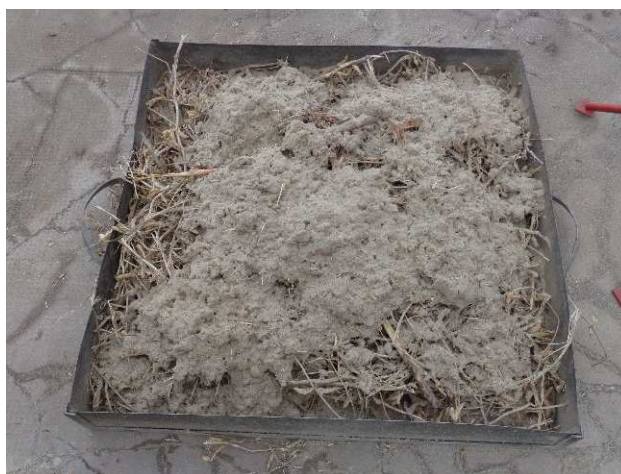
Figura 6: Bandeja de evaluación preparada con combustible tipo "A": residuo de cosecha de soja y sorgo.
