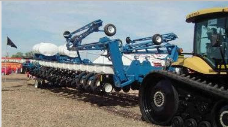
Imagen 1. Kinze de 36 hileras a 76 cm: 27 metros de ancho de labor.
