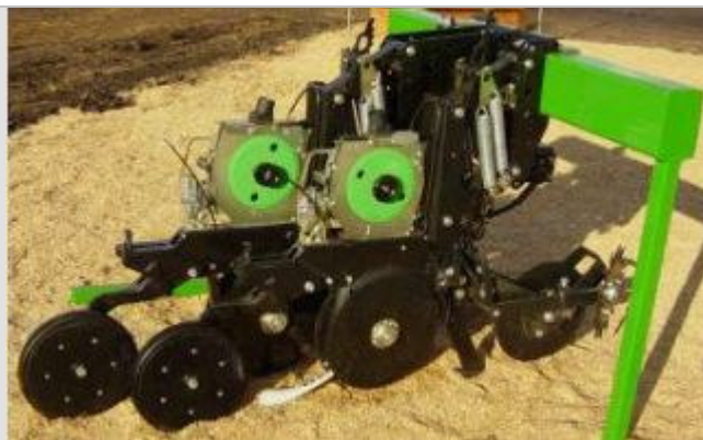
Imagen 2. Green PlainT, distribuidor mecánico para Soja de placa vertical.
