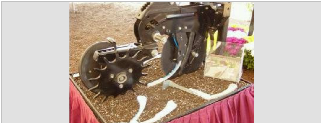
Imagen 4. Esquema de aplicación de fertilizante líquido con colita fijadora de semilla.
