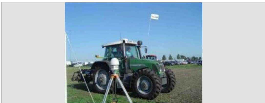
Imagen 11. Piloto automático AGCO, Tractores alemanes FENDT, con base estacionario. Entre otros esto se vio en Trimble, en JD, en Case/New Holland y otros proveedores particulares.
