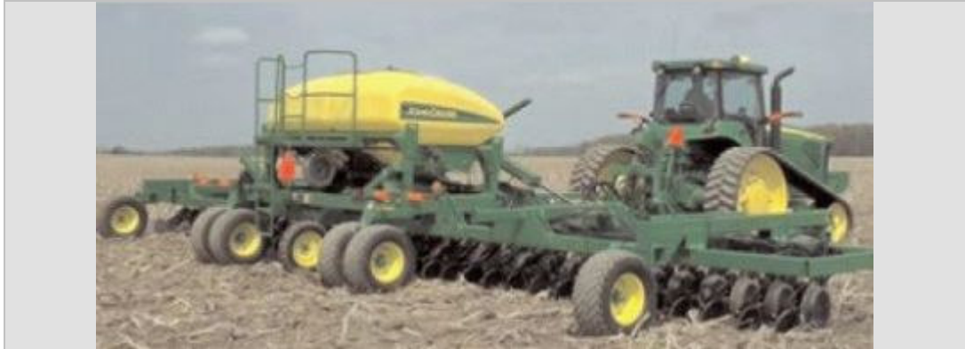
Imagen 1: Sembradora JD Air Drill para la siembra de soja a 38 cm. Exclusivamente. Nueva tendencia en siembra de soja en E.E.U.U.
