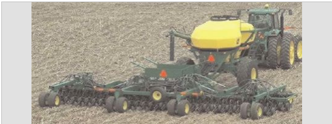
Imagen 1: Sembradora JD Air Drill tipo Triguera con divisor de semilla tipo copa sobre el chasis que soportan los trenes de siembra. Para soja la tendencia parece cambiar el diseño.
