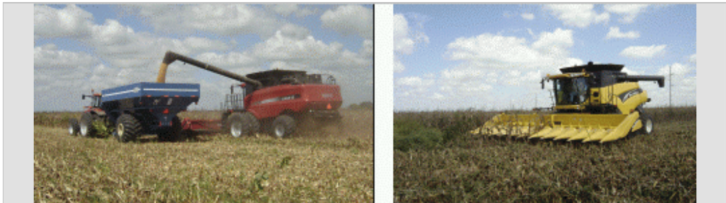
Figura 8. CASE AFX, con motor de 440 HP y un solo rotor axial (izq). NEW HOLLAND con motor de 426 HP y dos rotores axiales de trilla (der). Se puede apreciar el diseño del carrozado con una cuidada estética. Estas cosechadoras comparten el 70% de los componentes de fabricación y salen de la misma fábrica, ahora radicada en la ciudad de Gran Island, Nebraska.
