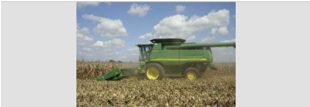
Figura 4. John Deere 9860 STS de flujo axial y cabezal maicero de 12 hileras a 0,76 cm; más de 65 tn/hora de maíz durante la dinámica.
