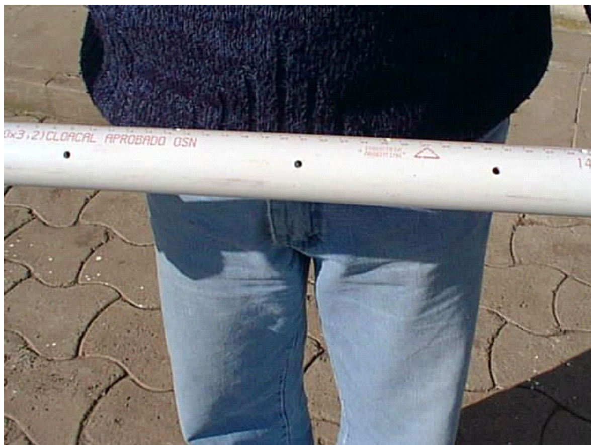
Foto 2: Tubo de plástico con orificios para las muestras inoculadas y testigo.
