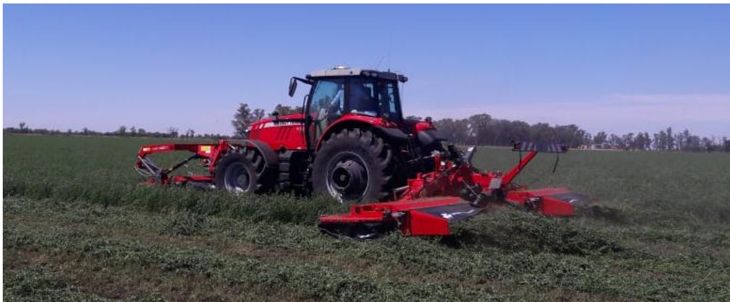
Figura: Tractor Massey Ferguson 7722 con triple Segadora con acondicionador de goma DM8312 TL RC / 306 FZ – RC
