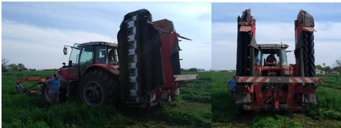
Figura: detalle de sistema de plegado tipo libro
