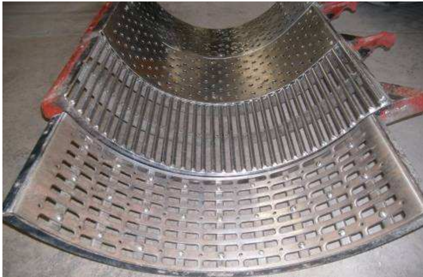
Figura 3. Vista de diversos cóncavos de trilla del girasol; según condiciones del cultivo.
