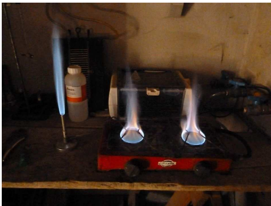
Figura 7: Quemadores encendidos con el biogás de los biodigestores del mercado san miguel.
