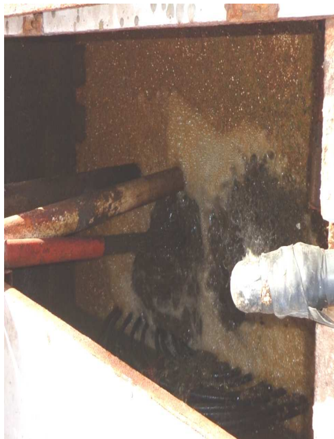
Figura 6: Ingreso de la materia prima molida a la cámara de mezclado y calefacción. En la parte izquierda de la imagen puede apreciarse la serpentina intercambiadora de calor.
