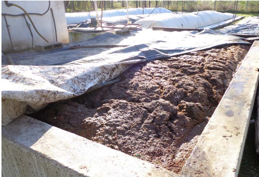
Figura 5: Residuos orgánicos triturados en la cámara donde se separa el sobrenadante o “costra”
